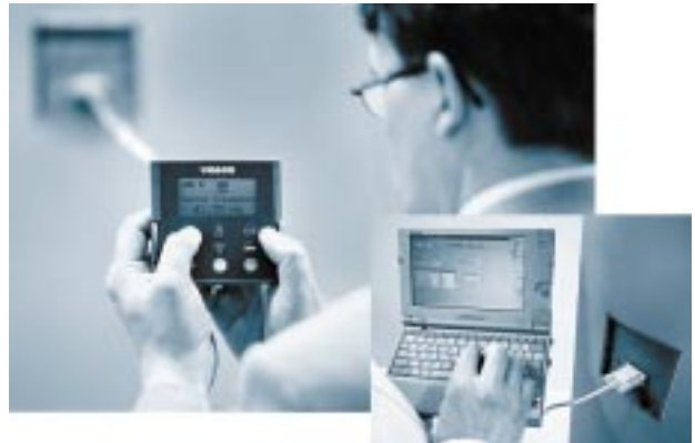
Zastosowanie łącza szeregowego RS232C.
